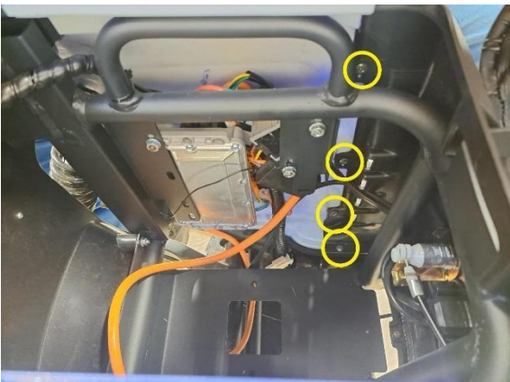
Irrota istuimen vasemmanpuoleisen alasivumuovin kiinnitysruuvit (ristipäämeisseli ph2).
