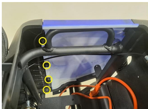
Irrota istuimen oikeapuoleisen alasivumuovin kiinnitysruuvit (ristipäämeisseli ph2).
